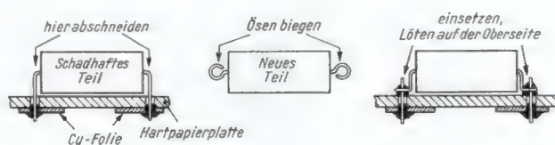
Bild 3. Austausch schadhafter Kleinteile bei einer gedruckten Schaltung
