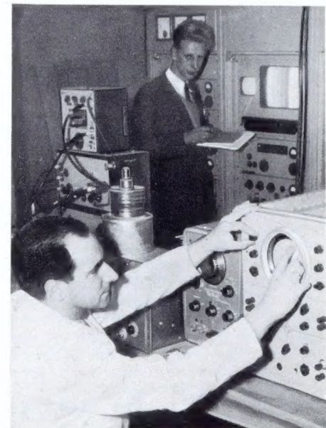
Die deutschen Ingenieure W. von Sekendorf (vorn) und M. Knof bei der Endprüfung des Siemens-Fernsehsenders GTV-9 in Melbourne
